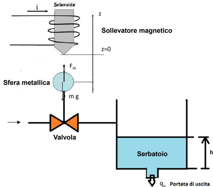
Figura 1: Sistema di regolazione del livello del liquido in un serbatoio attraverso una valvola azionata da un sollevatore magnetico (elaborato da P. Nucci)
