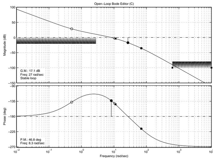
Figure 6: Diagrammi di Bode della funzione di trasferimento di anello  $C(s)G_\delta(s)$ , con  $C(s) = 0.7 \frac{2s+1}{s^2}$ .
