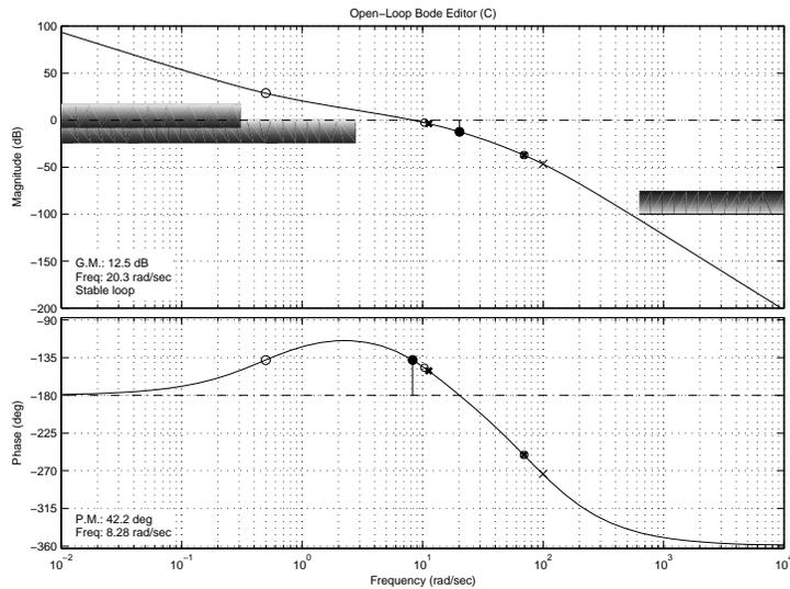
Figure 7: Diagrammi di Bode della funzione di trasferimento di anello  $C(s)G_\delta(s)$ , con  $C(s) = 0.7 \frac{2s+1}{s^2(0.01s+1)}$ .
