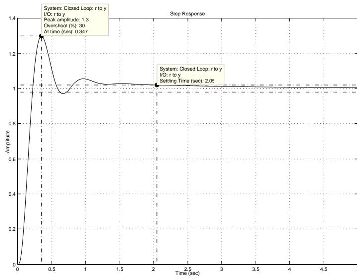
Figure 8: Risposta del sistema in anello chiuso al gradino unitario nel caso  $F_l = 0$ .
