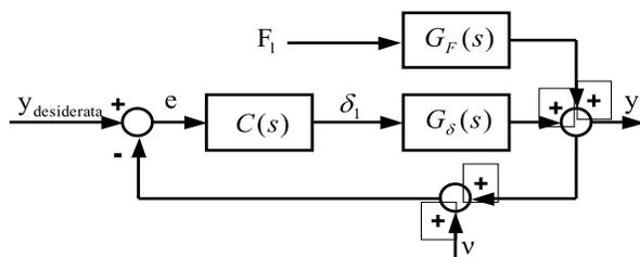
Figure 4: Schema del sistema di controllo da realizzare.
