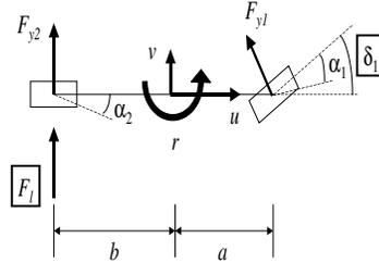
Figure 1: Modello monotraccia di autoveicolo
