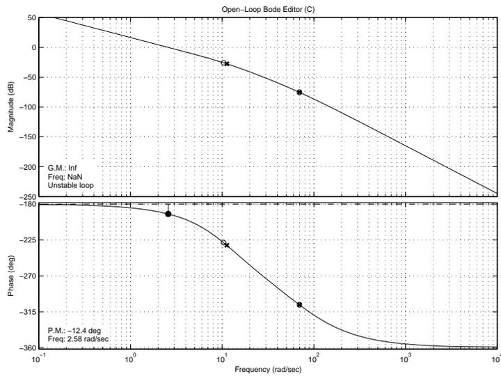
Figure 5: Diagrammi di Bode della funzione di trasferimento di anello  $C(s)G_\delta(s)$ , con  $C(s) = \frac{1}{s^2}$ .
